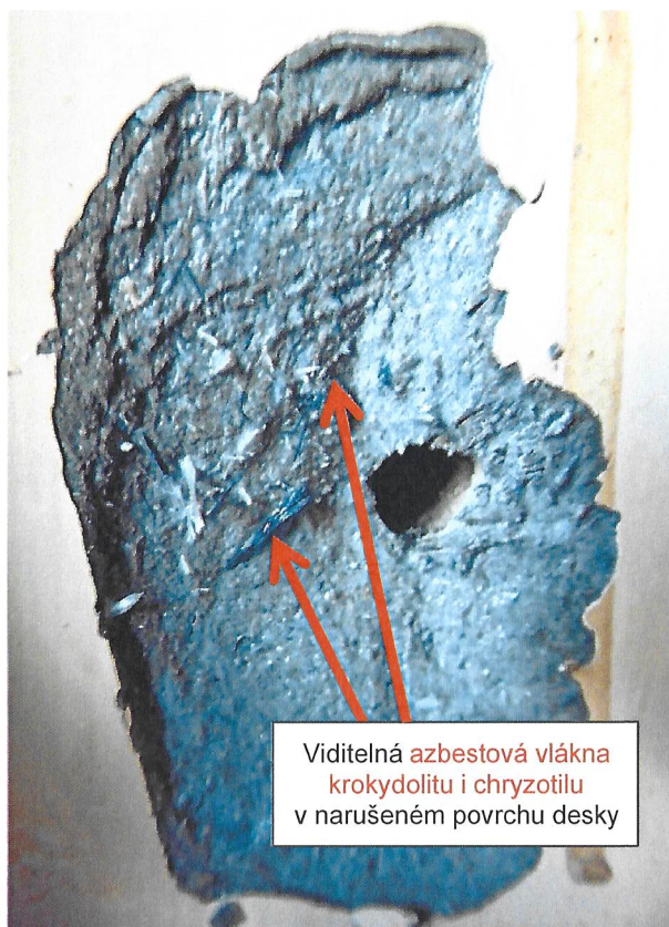
Foto č. 3 – DETAIL. Lokalizace místa odběru vzorku č. 2. Akumulátorovna. Azbestocementová konstrukční deska dělicí příčky mezi akumulátorovnou a sdělovací místností.
